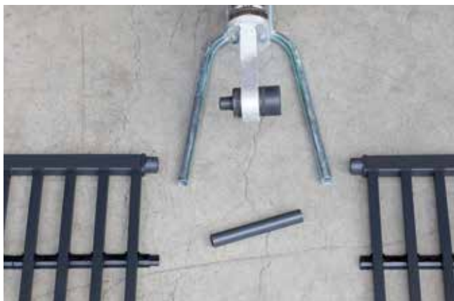
1. Schweißgeräte und Werkzeuge (16 mm) montiert; Temperaturkontrolle durchgeführt.
