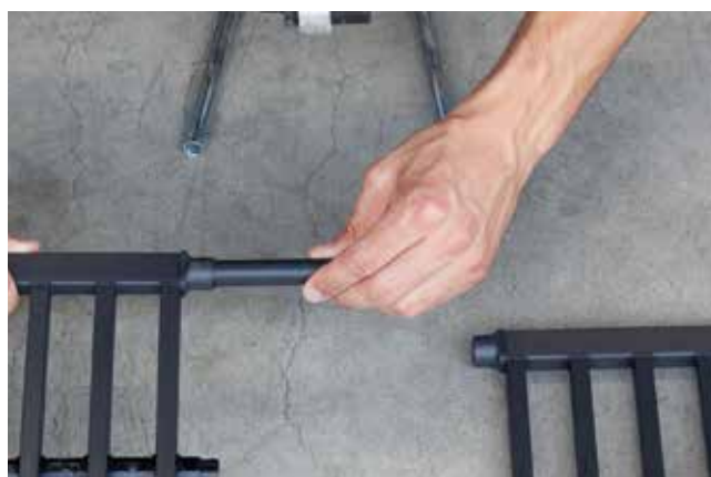
4. ... und sofort zusammenschieben (Schweißtiefe 13 mm).
