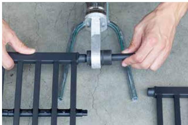
2. Heizrohr 16 mm in die Werkzeugbuchse einführen und gleichzeitig Muffe des Heizregisters auf den Heizdorn schieben.
