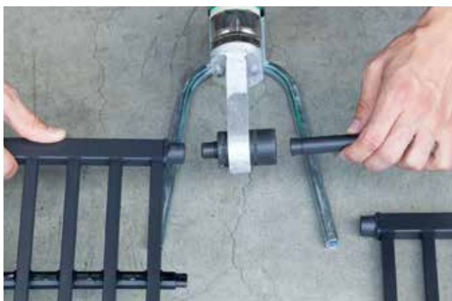
3. Nach der vorgeschriebenen Aufheizzeit von 5 Sekunden Teile von den Werkzeugen abziehen ...
